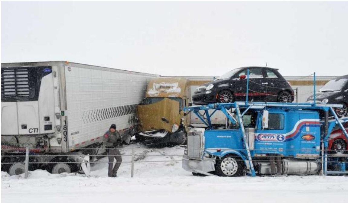
Figura 3-58: Semirremolques con pliegue transversal en la Interestatal 40 cerca de Amarillo en febrero de 2015. 325
